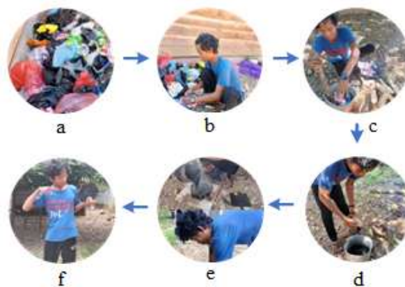
Gambar 2. Alur Proses Produksi Paving Block : (a) Pengumpulan dan pemilahan limbah plastik, (b) Pencacahan, (c) Peleburan plastik, (d) Pencampuran dengan pasir kali, (e) Pencetakan dan pemadatan, (f) Pendinginan dan pelepasan cetakan
