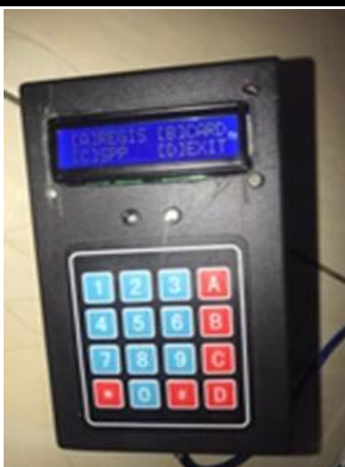
Gambar 4. Rangkaian RFID system untuk kartu pelajar cerdas sebagai absen
